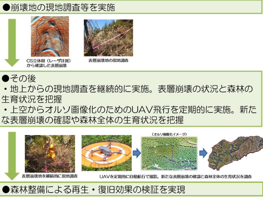
図7 復旧・再生効果の検証フロー
